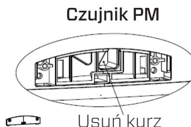
3. Wyczyść soczewkę czujnika wacikiem i wodą zgodnie ze wskazaniem strzałki. Następnie wytrzyj soczewkę czystym wacikiem.
