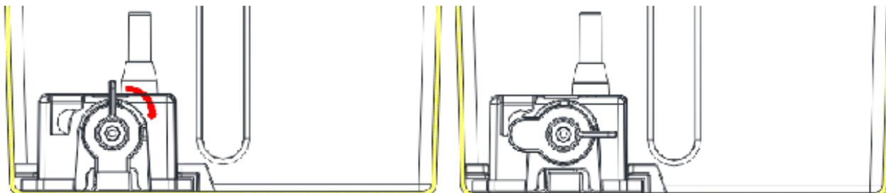
5. Scoateți pompa de apă din suport, consultați diagrama schematică din stânga.
