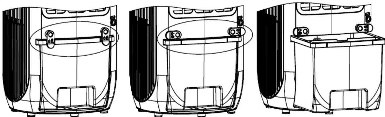
3. Tirez le réservoir d'eau à moitié en dehors de l'appareil.
