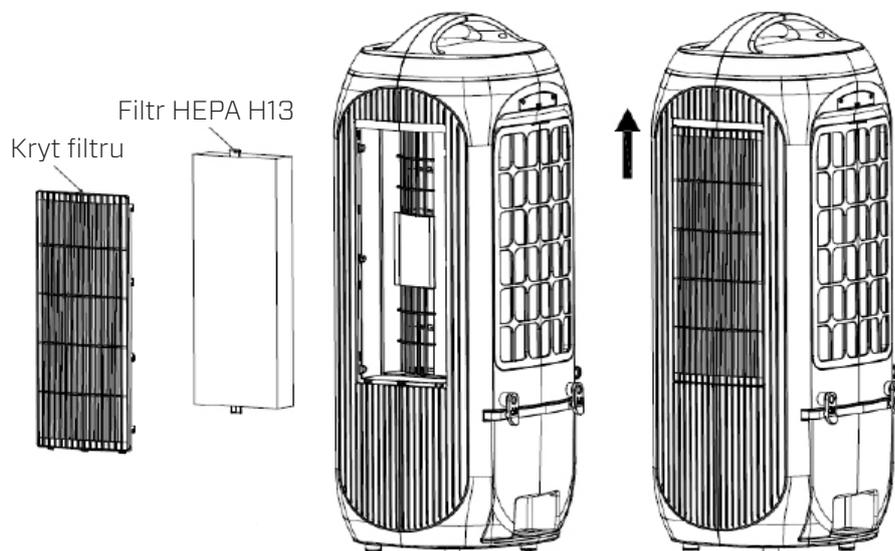
2. Posuňte kryt filtru na zadní straně nahoru a vložte odpařovací filtr.
