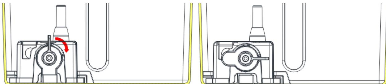
5. Schuif de waterpomp uit de beugel, zie het schematische diagram hier links..
