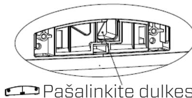
3. Jutiklio lęšį nuvalykite medvilniniu tamponu ir vandeniu, kaip nurodyta rodykle. Tada lęšį nusausinkite švariu medvilniniu tamponu.
