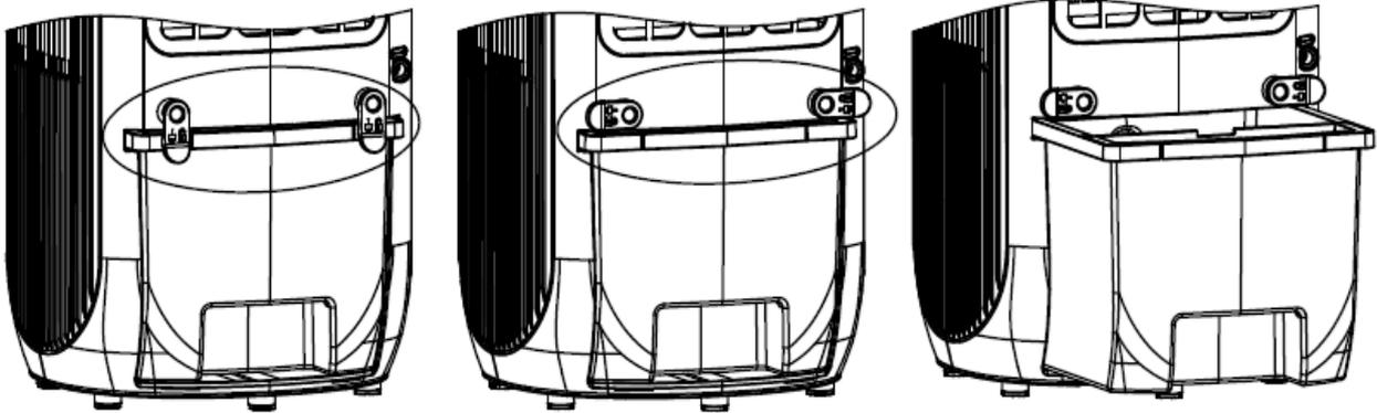
3. Ziehen Sie den Wassertank halb aus dem Gerät heraus.
