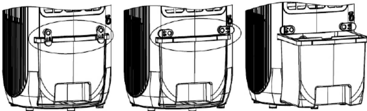
3. Wyciągnij zbiornik na wodę do połowy z urządzenia.
