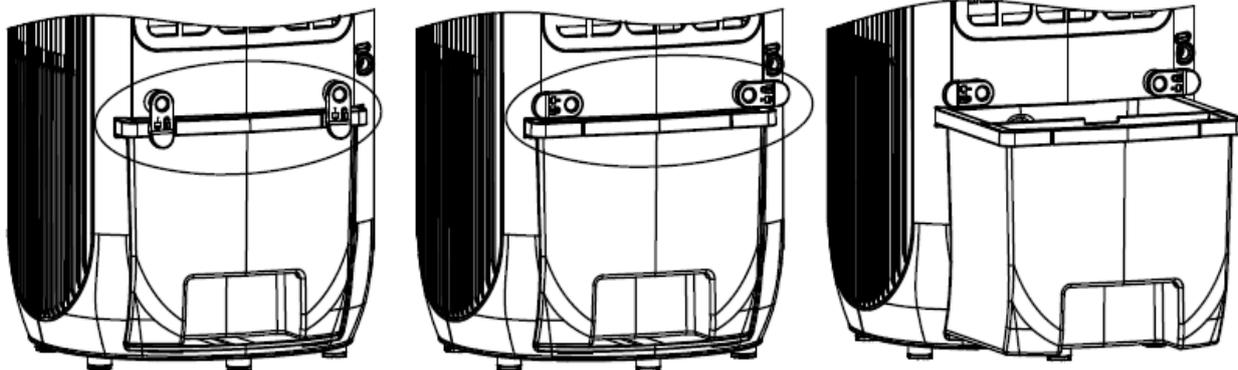
3. Vul de watertank met een gieter, houd hierbij rekening met de maximale waterniveau-indicator, zie voorzijde van het apparaat.
