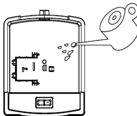
**Achtung:** Das Gerät nur mit frischem Trinkwasser befüllen. Die Wassertemperatur darf maximal 40°C betragen.
