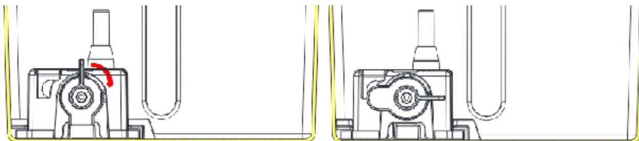
5. Vysuňte vodní čerpadlo z držáku, viz schéma zde vlevo.
