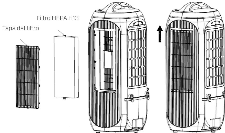
2. Deslice la tapa del filtro hacia arriba por la parte posterior para insertar el filtro evaporativo.
