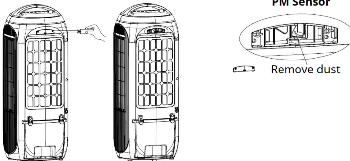
3. Nettoyez la lentille du capteur à l'aide d'un coton-tige et d'eau, comme indiqué par la flèche. Séchez ensuite la lentille à l'aide d'un coton-tige propre.
