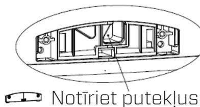
3. Notīriet sensora lēcu ar vates tamponu un ūdeni, kā norādīts ar bultiņu.
