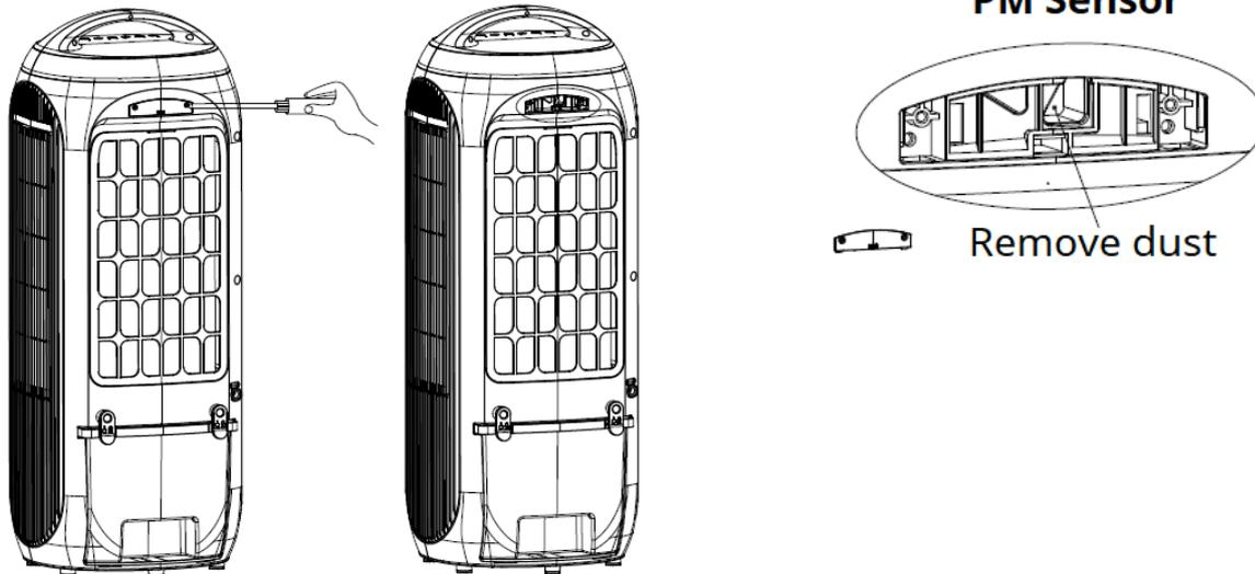
3. Maak de sensorlens schoon met een wattenstaafje en water zoals aangegeven door de pijl. Droog de lens vervolgens met een schoon wattenstaafje.
