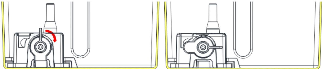
5. Schieben Sie die Wasserpumpe aus der Halterung, siehe schematische Darstellung hier links.
