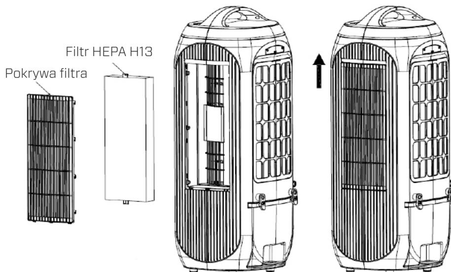
2. Przesuń pokrywę filtra z tyłu, aby włożyć filtr wyparny.
